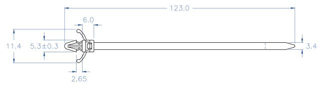
$\bigcirc$  HOLE IN CHASSIS:  $\emptyset 4.0^{+0.05}_{-0}$  mm
