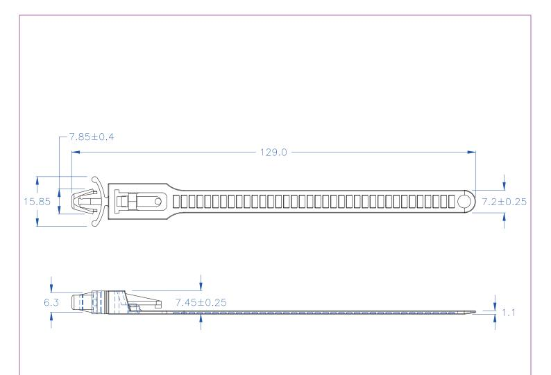
$\bigcirc$  HOLE IN CHASSIS:  $\emptyset 6.5^{+0.05}_{-0}$  mm
