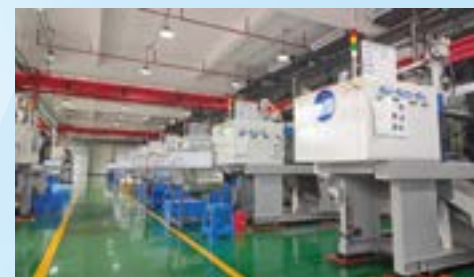
日本TOYO 全電式塑膠射出機 TOYO Fully Electric Injection Molding Machine
