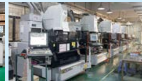
日本SODICK 高速放電成型加工機 SODICK CNC Electric Discharge Machine
