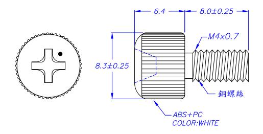
DRAW NO. PGAS035447 GJS PLASTIC TOLERANCE: 網頁圖示供參考, 最終以品固公司正式圖面為主 品固企業股份有限公司 品基電子(東莞)有限公司 蘇州品基電子科技有限公司 L≤10 ±0.2 The plastic tolerance is just for your reference; all 10<L≤30  $\pm 0.3$ the measurements and dimensions are according 東莞市钻隆商貿有限公司 30<L≤50 ±0.5 to the "DATA SHEET" issued by PINGOOD. 鑽隆有限公司 50<L≤100 ±0.7 PART NAME: MATERIAL: ABS+PC VERSION 100<L≤250 ±1.2 螺絲 銅 ABOVE 250 ±1.5 2A**SCREW** SIZE COLOR: WHITE SCALE UNIT PART NO: SHEET 1 OF 1 SW4-08-AKO mm
