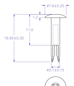
$\bigcirc$  HOLE IN CHASSIS:  $\emptyset 3.2^{+0.05}_{-0}$  mm
