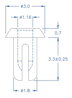
$\bigcirc$  HOLE IN CHASSIS:  $\emptyset 1.9^{+0.05}_{-0}$  mm
