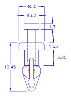
O HOLE IN CHASSIS: Ø3.1
