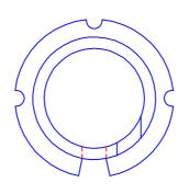
**ø**6.2±0.3 (置入**ø**5.05治具後量測)
