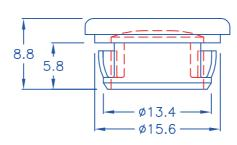
O HOLE IN CHASSIS: Ø13.5
