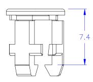
$\bigcirc$  HOLE IN CHASSIS:  $\emptyset 7.0^{+0.05}_{-0}$  mm
