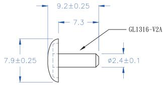
$\bigcirc$  HOLE IN CHASSIS:  $\emptyset 5.0^{+0.05}_{-0}$  mm
