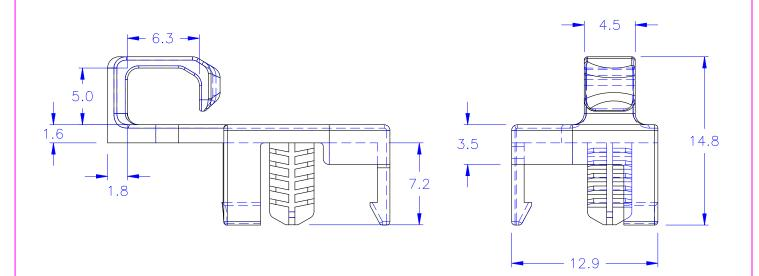
$\odot$  HOLE IN CHASSIS:  $\emptyset 4.3^{+0.05}_{-0}$  mm  $\odot$  CHASSIS THICKNESS:  $5.0^{+0}_{-0.05}$  mm
