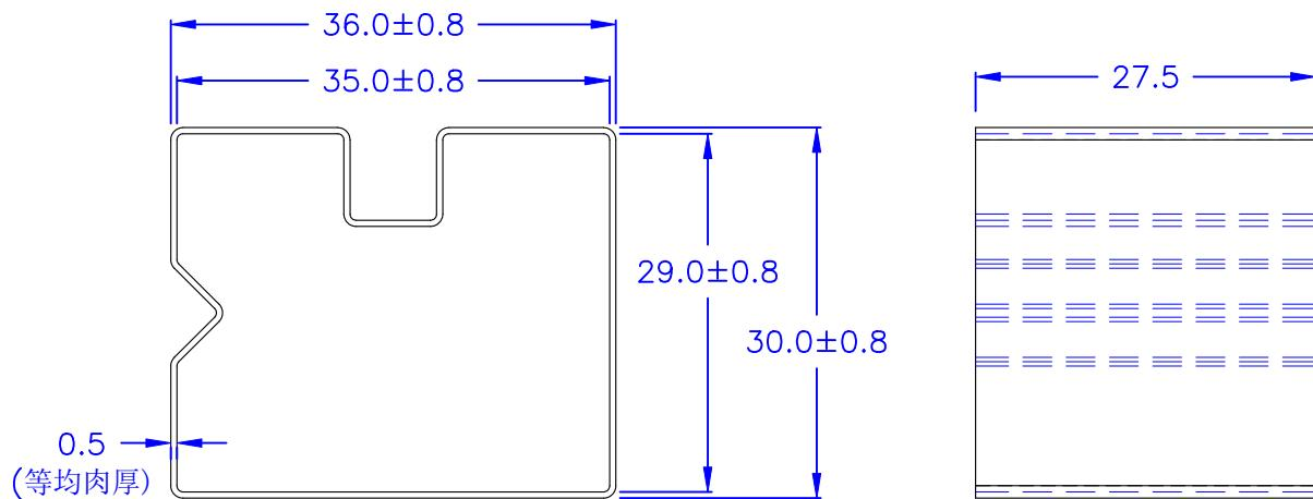
◎ 產品很薄，裸空處太大，彎曲屬於正常現象。檢測以放入治具量測為主。
