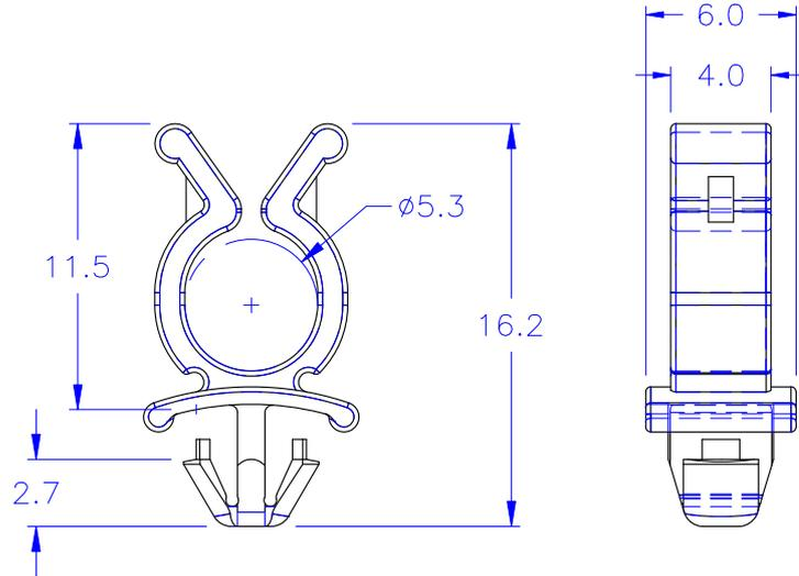
◎ HOLE IN CHASSIS:  $\phi 4.3^{+0.05}_{-0}$  mm
