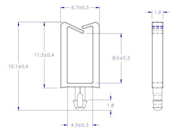
$\bigcirc$  HOLE IN CHASSIS:  $\emptyset 1.8^{+0.05}_{-0}$  mm
