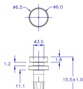
O HOLE IN CHASSIS: Ø3.6
