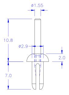
$\bigcirc$  HOLE IN CHASSIS:  $\emptyset 3.0^{+0.05}_{-0}$  mm
