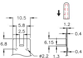
DRAW NO. PGAS029121 GJS PLASTIC TOLERANCE: 品固企業股份有限公司 網頁圖示供參考, 最終以品固公司正式圖面為主  $\pm 0.2$ L≤10 品基電子(東莞)有限公司 The plastic tolerance is just for your reference; all 蘇州品基電子科技有限公司 10<L≤30  $\pm 0.3$ the measurements and dimensions are according 東莞市鑽隆商貿有限公司 30<L≤50 ±0.5 to the "DATA SHEET" issued by PINGOOD. 50<L≤100 ±0.7 PART NAME: MATERIAL: VERSION 100<L≤250  $\pm 1.2$ 把手蓋 ABS+PC VO or EQUIVALENT ABOVE 250  $\pm 1.5$ EJECTOR COVER SIZE COLOR: RED (紫紅色) SCALE UNIT PART NO: MHL-24-A9R2 SHEET 1 OF 1 mm
