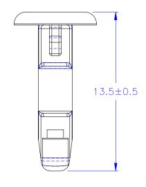
$\odot$  HOLE IN CHASSIS:  $\emptyset 3.0^{+0.05}_{-0}$  mm
