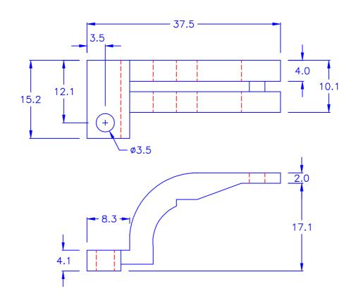
DRAW NO. PGAS018831 GJS 品固企業股份有限公司 PLASTIC TOLERANCE: 網頁圖示供參考, 最終以品固公司正式圖面為主 品基電子(東莞)有限公司 ±0.2 L≤10 The plastic tolerance is just for your reference; all 蘇州品基電子科技有限公司 10<L≤30  $\pm 0.3$ the measurements and dimensions are according 鑽隆有限公司 PINGOOD ENTERPRISE CO.,LTD. 30<L≤50 ±0.5 to the "DATA SHEET" issued by PINGOOD. 50<L≤100  $\pm 0.7$ PART NAME: MATERIAL: PMMA **VERSION** 100<L≤250 ±1.2 導 光 棒 COLOR: NATURAL ABOVE 250  $\pm 1.5$ 1*A* LIGHT PIPES SIZE SCALE UNIT PART NO: LEAD-2 SHEET 1 OF 1 mm
